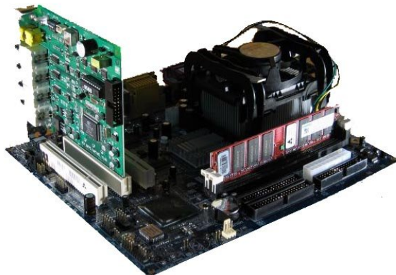
Abbildung 1: Das Installieren der Videokarte
